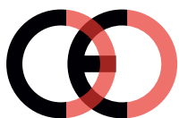
Falsk CE-mærke (for tæt på hinanden)
